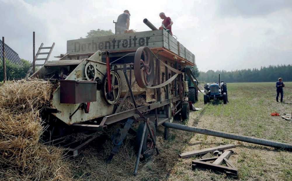
Het telen van bijzondere graansoorten op kleine percelen trekt vaak ook de aandacht van clubjes mensen die interesse hebben in oude landbouwtechnieken en -machines. Op de percelen van Het Loonsche Land die in gebruik zijn bij Piet van Laarhoven werd op 15 augustus 2020 het graan gedorst met een ouderwetse dorskast. Die werd via een riem door een tractormotor aangedreven (fotograaf onbekend).
